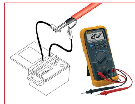
Izmjerite i pribliježite vrijednost otpora grijaće petlje te stanje izolacije, ne zaboravite napraviti fotodokumentaciju s vidljivim smještajem spojnice i završetka.
